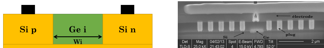
Fig. 1: Gauche : vue schématique en coupe d'un détecteur Si/Ge/Si ; droite : Image par microscopie électronique à balayage (MEB) de la même structure de détection. (fabrication au CEA-Leti)
