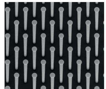
Épitaxie d'un réseau de nanofils de GaP sur  $\text{SiO}_2$
